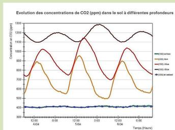
Exemple de gradient de  $\text{CO}_2$  et de  $\text{CH}_4$  dans un lysimètre du plateau Macrocosmes.
